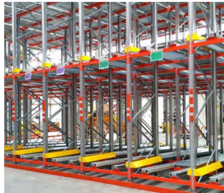
**Variante :** palettier dynamique à gravité inversée (Push-back pallet rack). Le chargement et le déchargement est réalisé du même côté. Lorsqu'une palette est ajoutée, elle pousse vers l'arrière les palettes précédemment stockées sur la même rangée.
